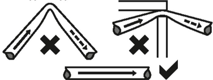
**9** Конец выпускной трубы рекомендуется не опускать ниже 2 метров относительно насосного модуля. В противном случае будет наблюдаться «сифонный эффект» и для его подавления будет необходимо установить антисифонный клапан в одном из допустимых мест (см. рисунок).
