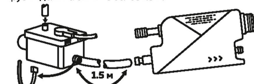
**8** Подсоедините к насосу выпускную трубку 6x9 мм, затянув соединение хомутом-стяжкой. Проверьте, чтобы на всем протяжении трубы не было заломов и других препятствий для свободного отвода конденсата.
