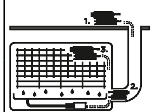
**5** Для предотвращения распространения вибрации и шума закрепите насосный модуль при помощи входящей в комплект самоклеющейся подложки.
