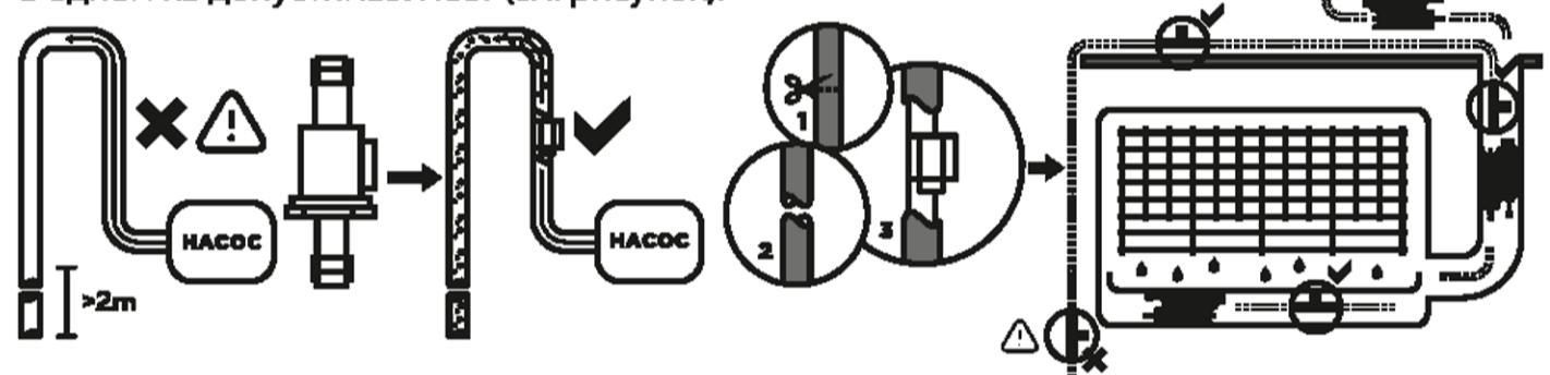
**10** Подключите насос к сети электропитания. Для того, чтобы предотвратить ущерб из-за протечек в случае выхода дренажного насоса из строя, настоятельно рекомендуется подключить аварийную опцию (ALARM). Коммутационная способность контактов аварийной схемы ЗА-/~240В. Если в вашем случае этого недостаточно, используйте дополнительное реле (см. схему).
