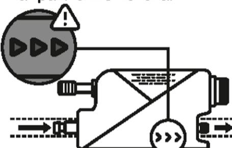
**7** Соедините насосный модуль и датчик трубкой 6x9 мм и укрепите соединения хомутами-стяжками. Длина трубы должна быть не более 1.5 м.
