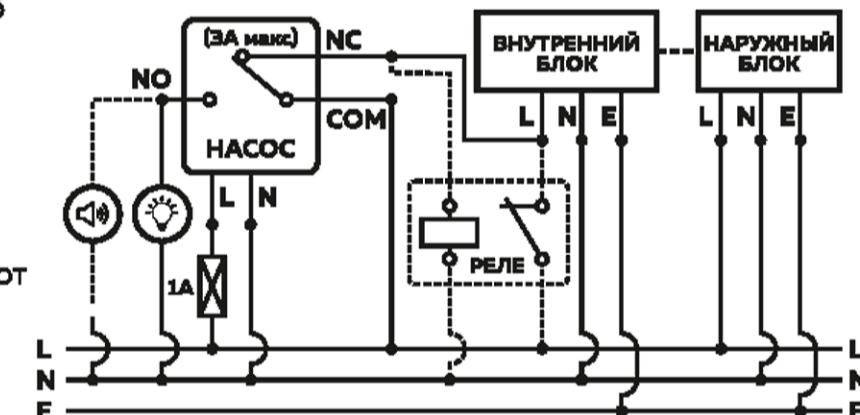
**11 ПРОВЕРКА.** Постепенно наполняя водой поддон испарителя кондиционера дождитесь включения и последующего выключения насоса. Повторите испытание, увеличив скорость наполнения. Убедитесь в корректном отрабатывании аварийной ситуации – отключении установки при достижении водой аварийного уровня. Удостоверьтесь в отсутствии протечек в дренажной системе.
